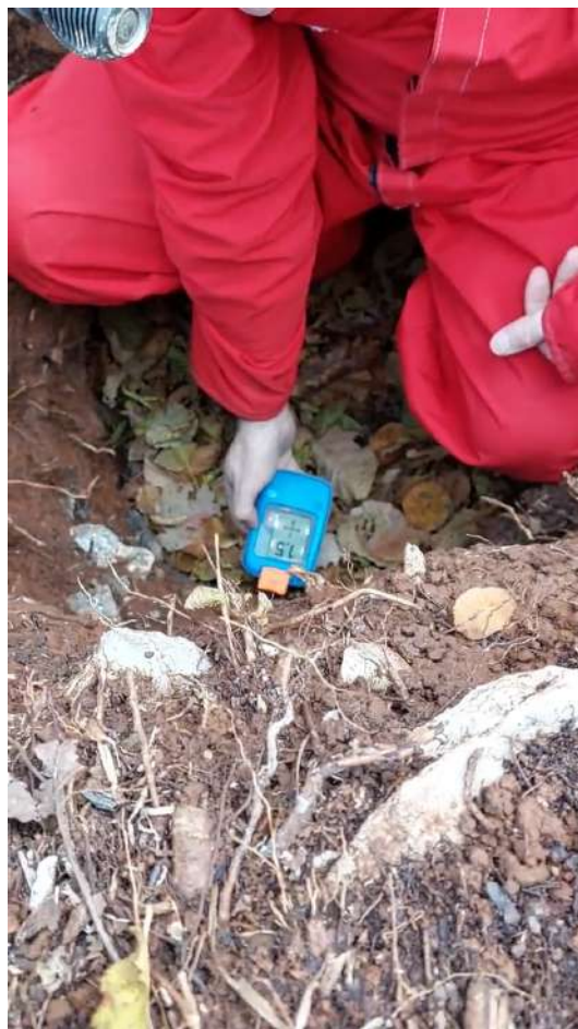
Con l'ARTVA si misura la distanza che manca per collegarsi con la grotta (foto M. Bottegal)
